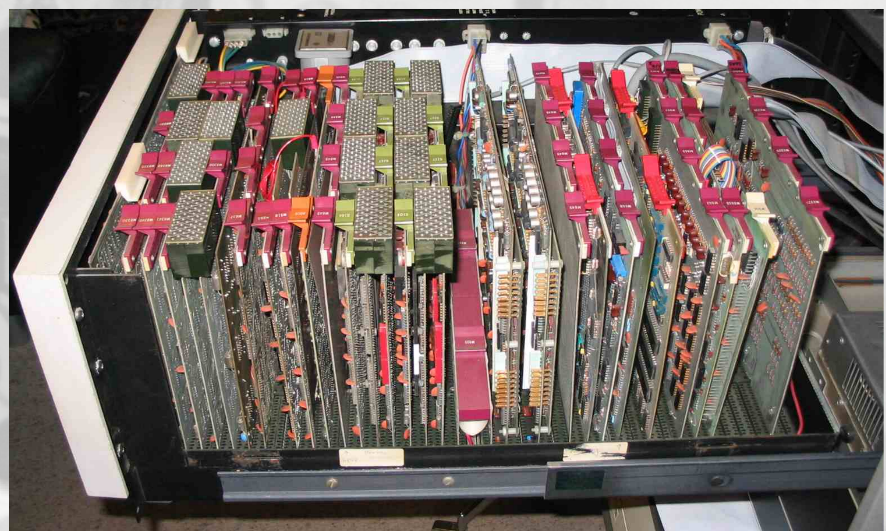
PDP-8:ns flip chips, som lätt kan bytas ut.
