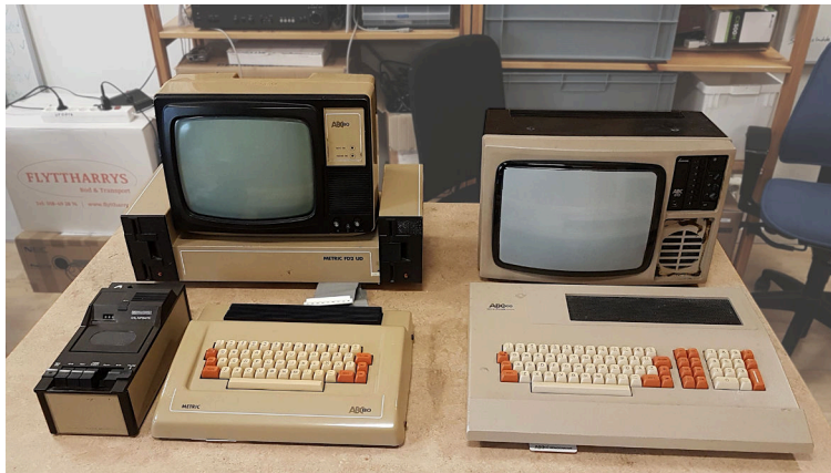
T.v. syns ABC 80 med bandspelare ABC 820, diskettenhet FD2 UD, samt bildskärm; t.h. en ABC 800 med bildskärm
