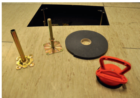
En isärplockad stötta, kompriband för tätning och tryck, samt en sugkopp för att lyfta plattor.
